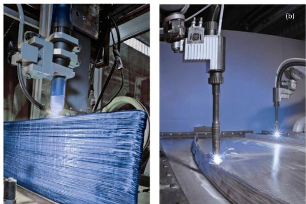
圖3 伯樂銲接之銲線電弧沉積層製造技術(a)示意圖；(b)實際銲接情況[7]
