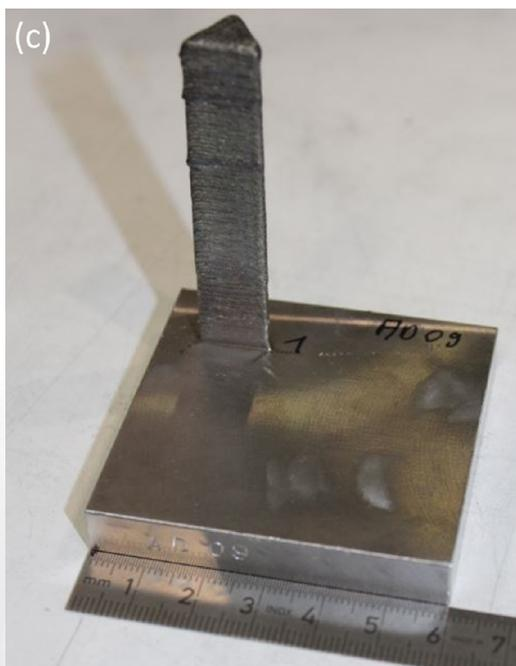
圖7 德國同軸雷射配搭廣泰極細線之3D列印初步成品
