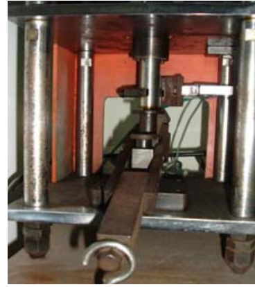
圖 3：環對盤粘著磨耗設備圖
